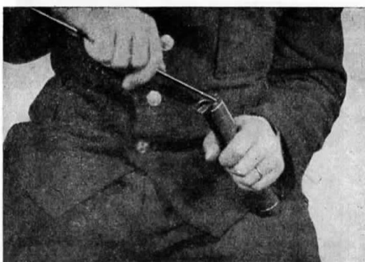
Obr. 26. Vynětí vytahovače
